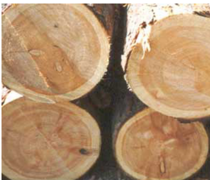
Rundholz, Lärche, Kern- und Splintholzanteil sichtbar
