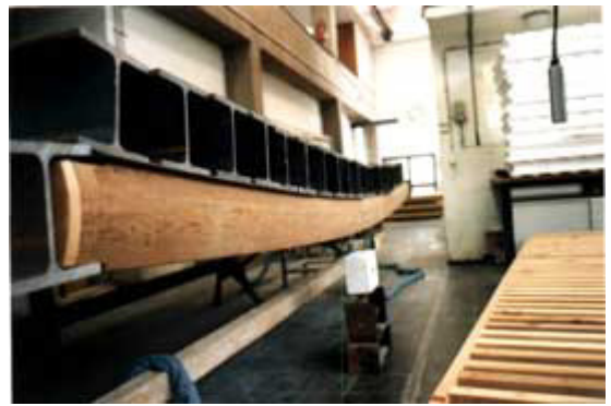
Früherer Belastungsversuch nach ZTV-Lsw88, Punkt 7.2.3, Western Red Cedar
