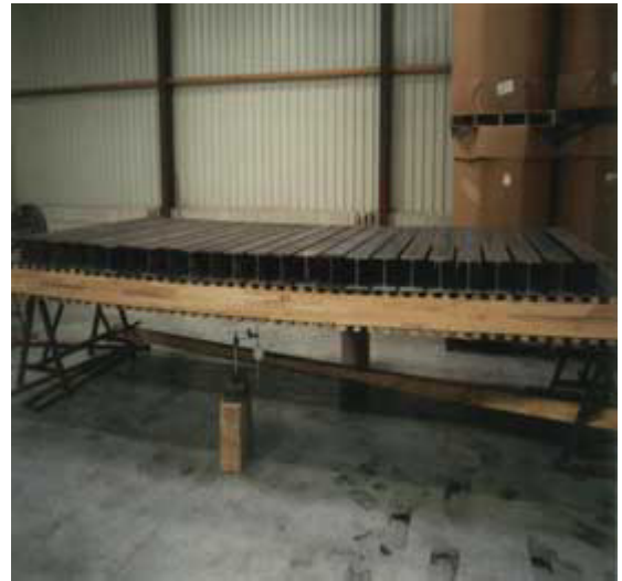
ZTV-Lsw88 7.2.3, Belastungsversuch, Akazie/Robinia, erfolgreiche Versuchsanordnung
