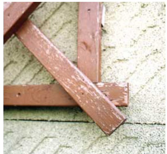
falsch: Lasur auf Kesseldruckimprägnierung
